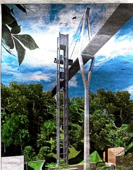
Der Aufzugsschacht ist gestalterisch und baulich von der Brücke getrennt.
